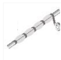
11 - CALORIFUGER LES LIAISONS (ADHESIF NON FOURNI)
